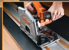
Пила оборудована специальными регулируемыми фиксаторами для установки на шину без люфта
