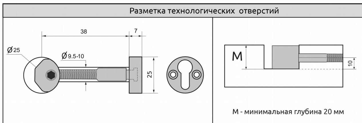
Для предотвращения вращения соединяемых деталей относительно друг друга, дополнительно можно использовать шканты.
