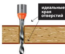
Монолитные сверла изготовлены из цельного твердосплавного прутка. Эта серия сверл имеет увеличенный ресурс и предназначена для максимальной производительности
