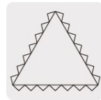
Para rebajar esquinas y puntos de soldadura
